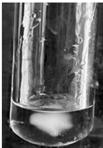
Рис. 5. Появление кристаллов ЦС в блок-полимере стирола при понижении температуры до 5°C.
