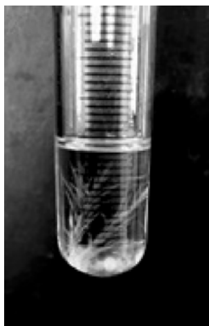
Рис. 6. Кристаллизация ЦС в стироле при понижении температуры раствора до 5°C. Концентрация ЦС в стироле 6%.
