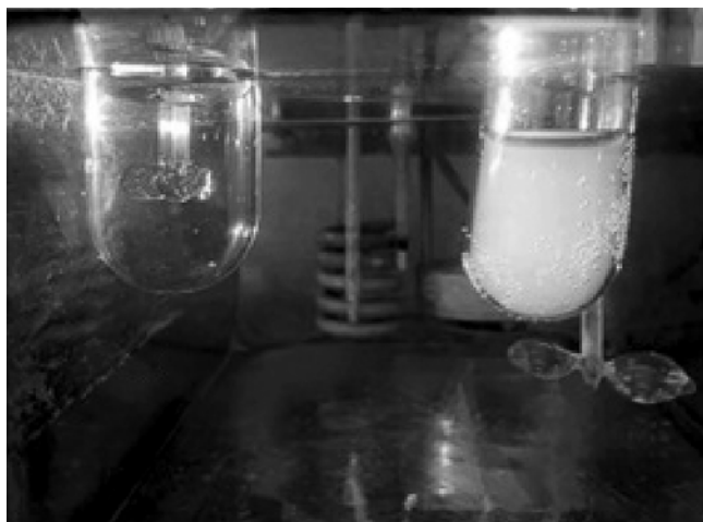
Рис. 2. Фотографии пробирок, в которых проводилась полимеризация в полустатическом (пробирка 1) и в статическом (пробирка 2) режиме.
