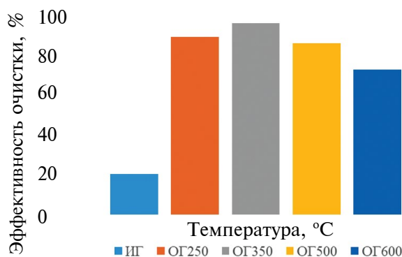
Рис. 7. График зависимости эффективности очистки растворов МГ от температуры обжига ОГ.
